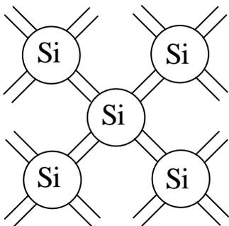
Пространственная схема образования ковалентных связей в собственных полупроводниках.
