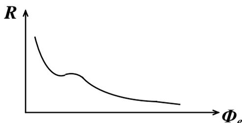
Сильная зависимость сопротивления полупроводников от освещенности используется в фоторезисторах (фотореле, датчики метро и т. п.).
