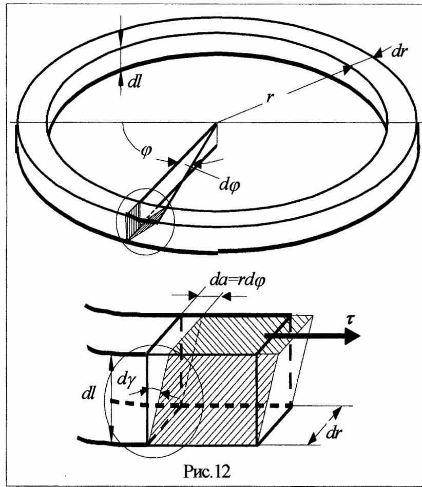
т.е. угол сдвига кольца равен радиусу кольца, умноженному на производную от угла закручивания стержня по длине.
